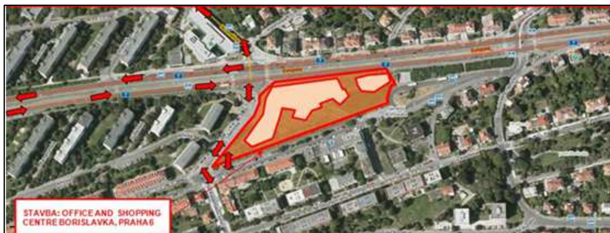
Obrázek 4 Situace hlavních příjezdových a odjezdových tras obslužné dopravy stavby
